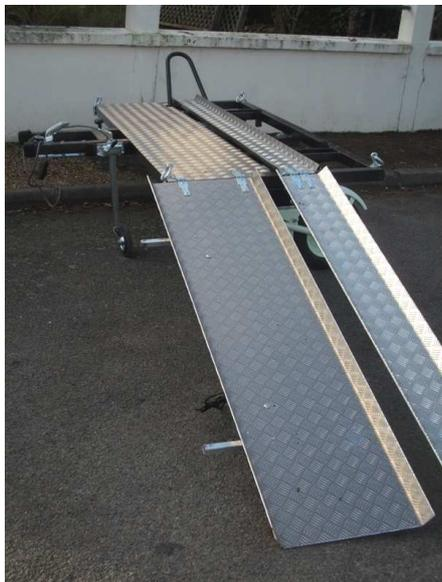
Les 2 rampes d'accès sont démontable et se rangent à l'arrière de la remorque dont une contient la signalisation
